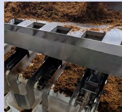
計量だけは手作業ではなく機械で精密に
