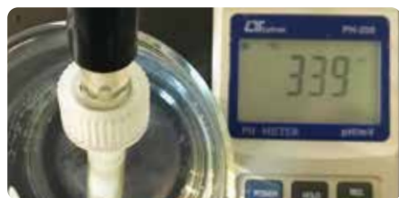
荘水を入れると339mVまで低下した ※ピーカー内の試験であり、体内の作用ではありません
